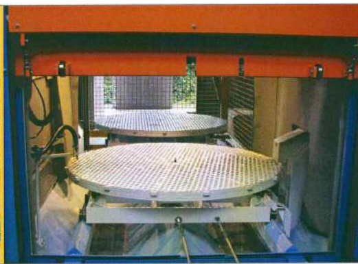
Beidseitig pneumatische Hubtüren
