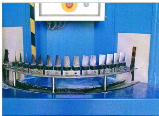
Nass-Strahlen von Turbinenschaufeln
